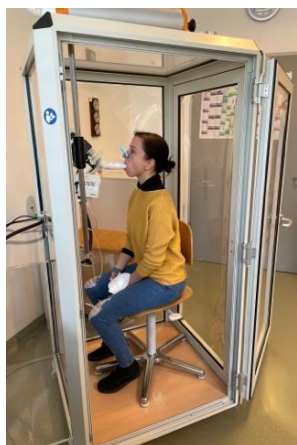
(Abb. 1 Aufbau Bodyplethymographie)
